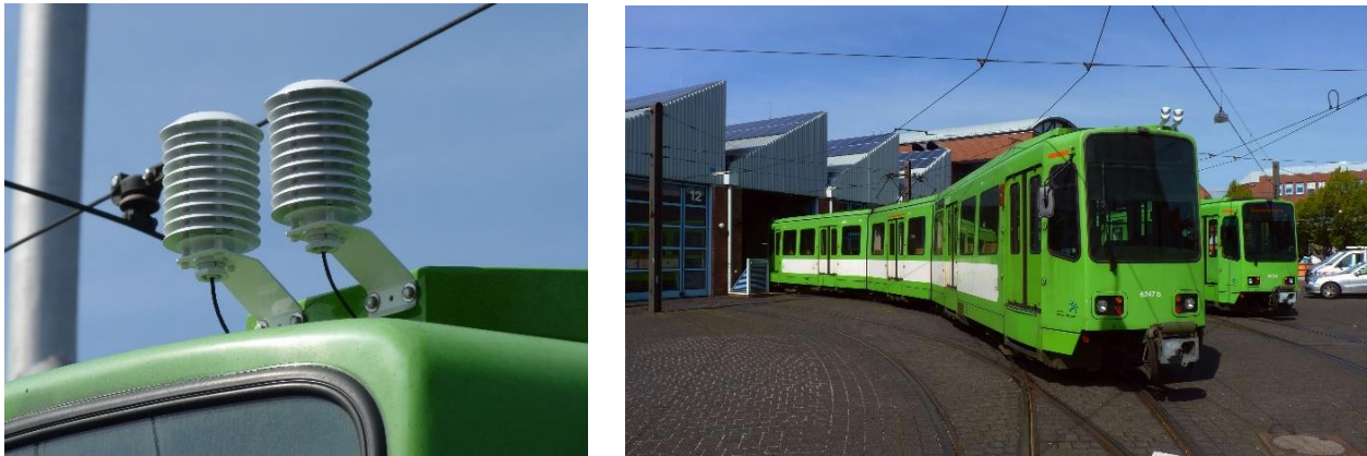
Abb. 8.1: Messsensorik an einer Tram in Hannover.
