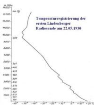
Abb. 1: Temperaturprofil (links) gemessen mit der Duckertsonde (rechts)
