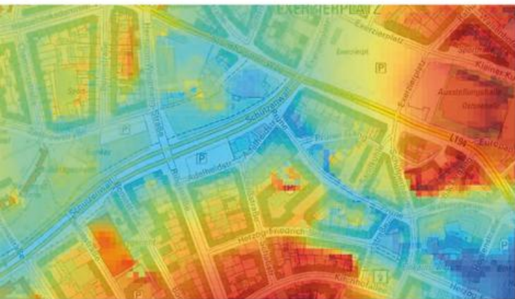
▲ Ausschnitt einer Reliefklassifikationskarte nach dem topographischen Klassifikationsindex für Flachland. Blaue Farben kennzeichnen Senken, an die bei Starkregen erhöhte Anforderungen an die Entwässerung gestellt werden. (Quelle: LLUR)
