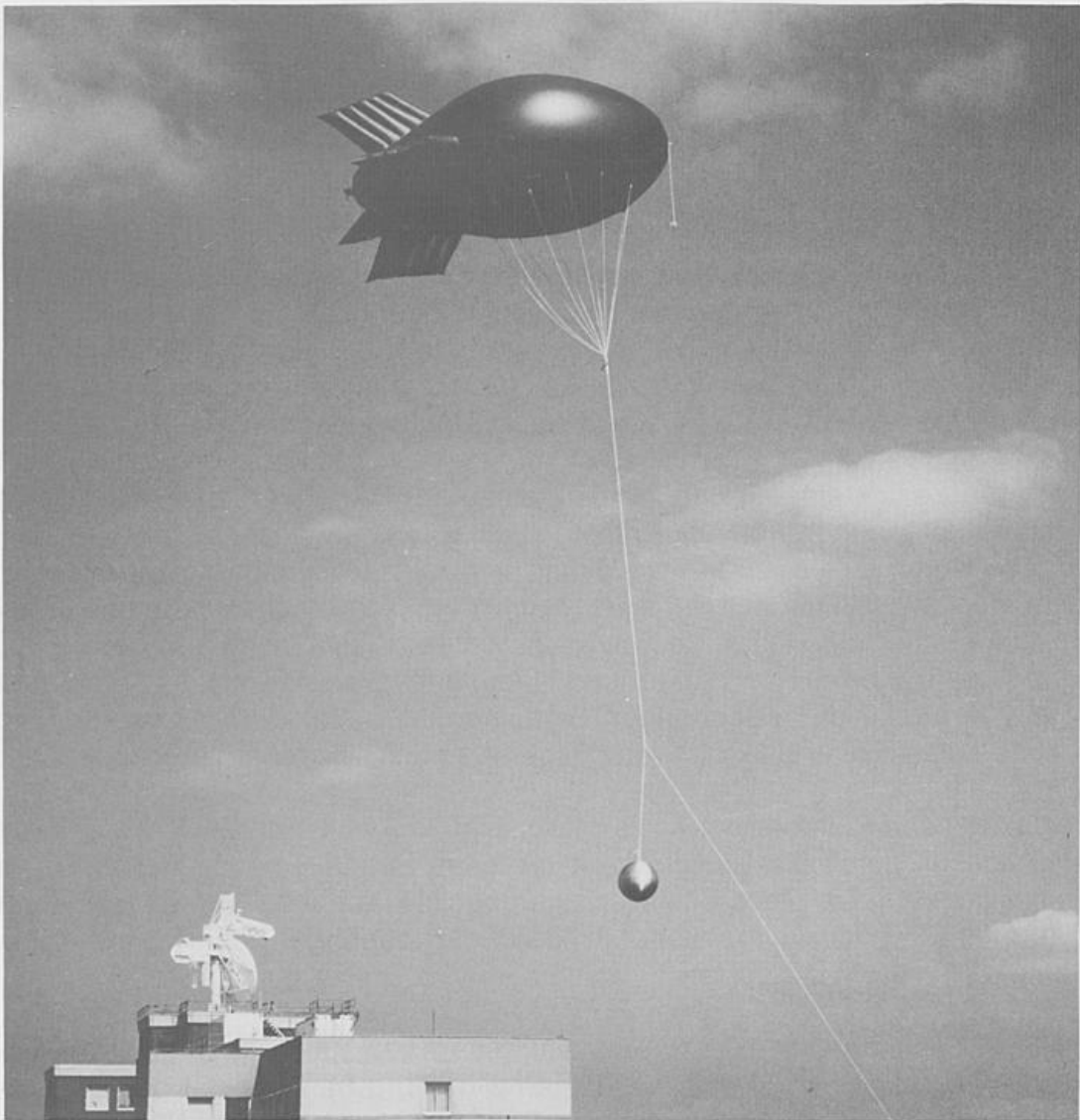
Bild 6 Eichung des Radars mittels einer an einem Ballon aufgehängten Kugel.
