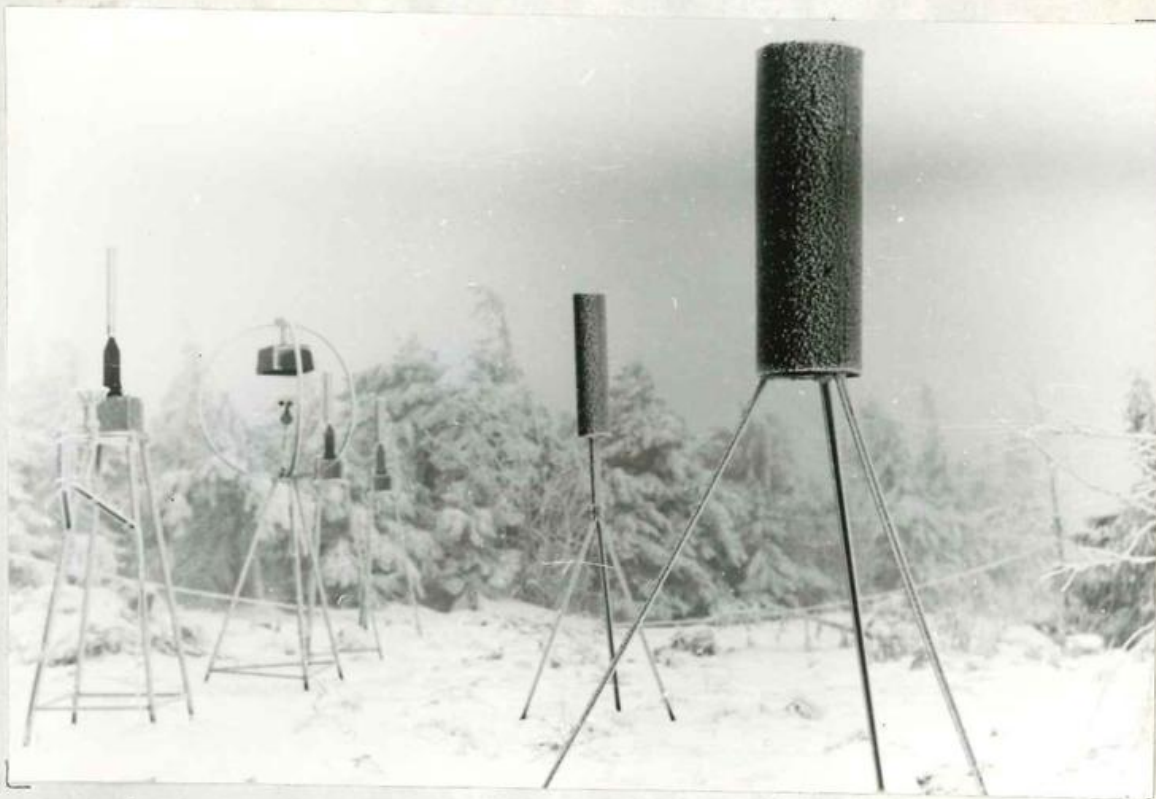
Abb.9 Meßanlage für Körper mit verschiedenem Durchmesser, Kleiner Fichtelberg
