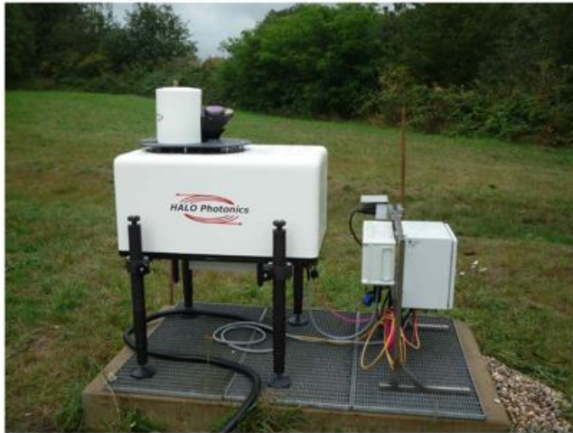
Abb. 1: Streamline-Lidar am MOL-RAO (links), Abtastschema für VAD-Scan: 12 Strahlrichtungen mit einem konstanten Elevationswinkel von 75^\circ (rechts)
