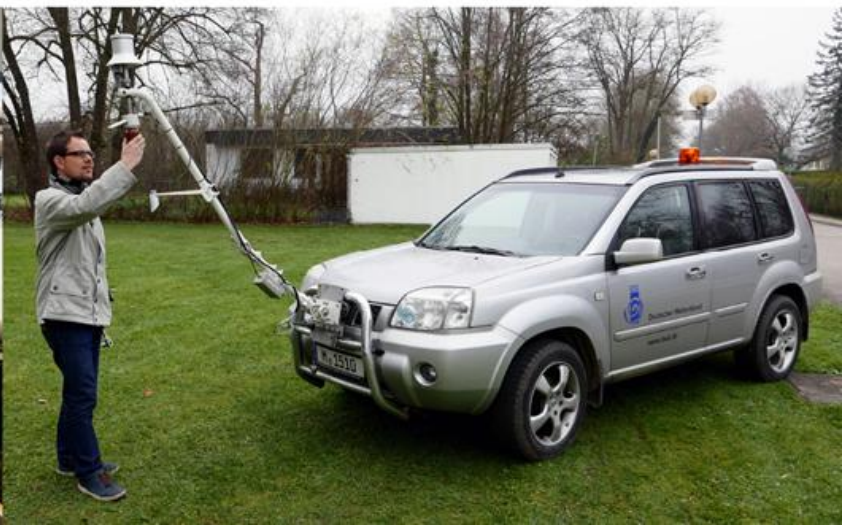
▼ Profilmessfahrzeug der Mobilen Messeinheit
