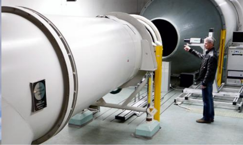
▲ Kalibrierung der Windsensoren im Windkanal in Oberschleißheim
