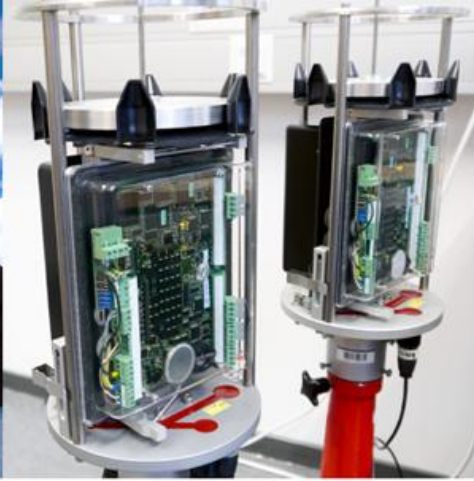
▲ Prüfung von Niederschlagsgebern OTT-Pluvio
