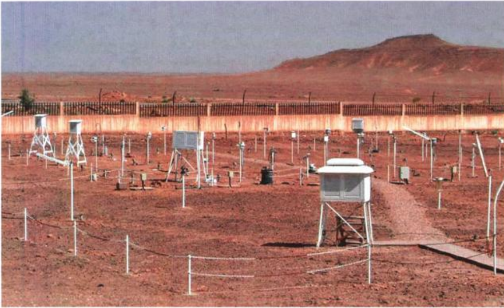
Abb. 9: Messfeld des WMO-Hüttenvergleiches 2008 – 2009 in Algerien (Quelle: WMO/TD-No. 1579, 2011)
