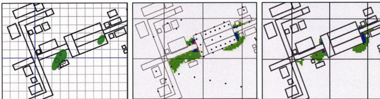
Abbildung 2: Exemplarische Ergebnisse des AGREE Modellvergleichs (Konzentrationsfelder in 0-2m über Grund, 240s nach Beginn der Freisetzung) links: AERMOD (Typ I), Mitte: LASAT (Typ II), rechts: MISKAM (Typ III).
