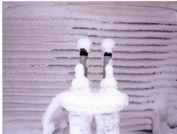
Abbildung 2: PT 100-Widerstandsthermometer und HMP 45D-Feuchtesensor nach Schneesturm.
