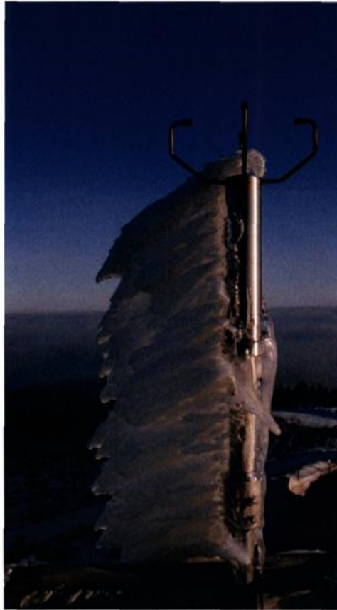
Abbildung 1: Extremes Klareis am Windsensor.
