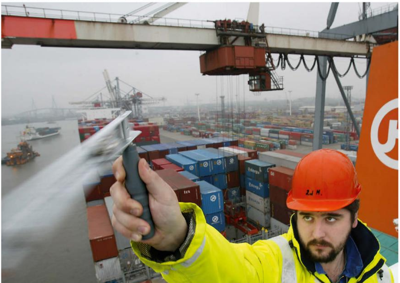
▼ Manuelle Erfassung von Lufttemperatur und Feuchte auf einem Containerschiff
