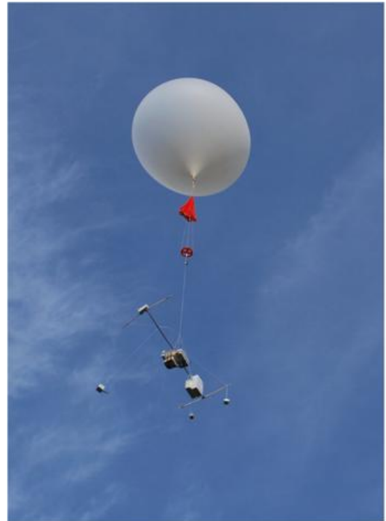
Abbildung 1: Ballon mit verschiedenen Radiosonden kurz nach dem Start
