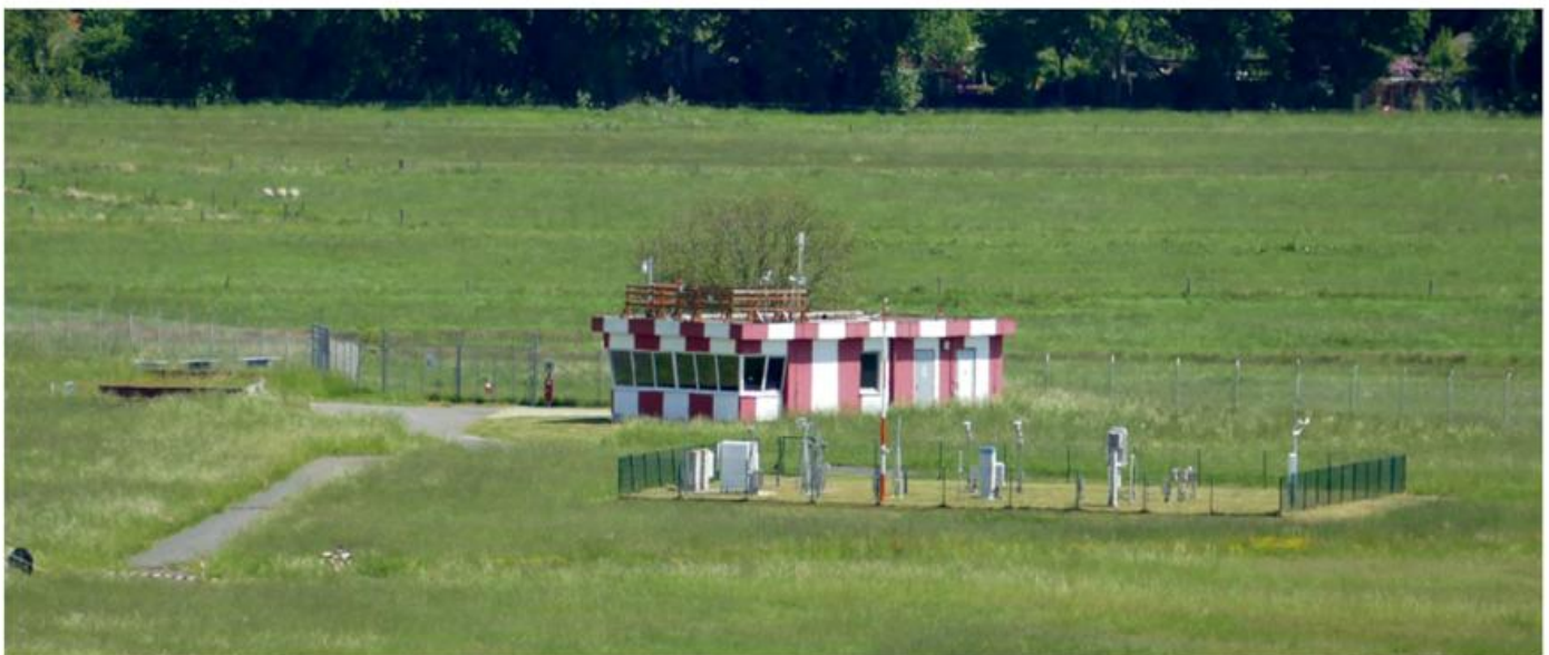
▲ Messfeld der Wetterstation Bremen. Hier werden unter anderem Luft- und bodennahe Temperaturen sowie Niederschlag, Globalstrahlung, Wind und der Bedeckungsgrad des Himmels gemessen.
