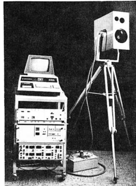
Abb. 4 DFVLR-Mini-Lidar für Aerosol-, Wolkenhöhen- und Schrägsichtmessungen
