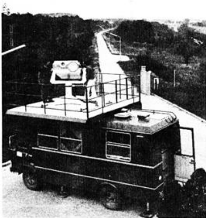
Abb. 3 Mobiles Aerosol Lidar der Firma Impulsphysik
