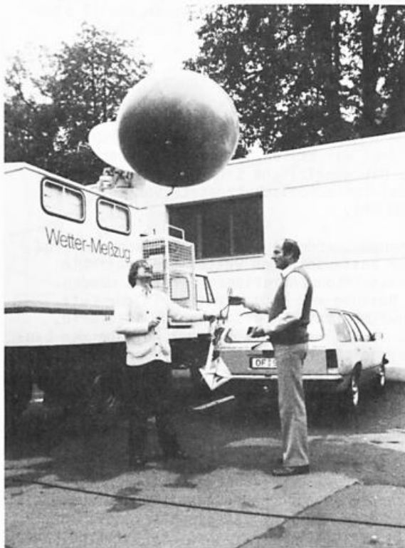
Kleinaerologische Radiosondenaufstiege im Rahmen des Smog-Warndienstes werden auch in Offenbach a.M., dem Sitz des Zentralamtes und des Wetteramtes Frankfurt durchgeführt. Hier Bedienste des Wettermeßzuges/Frankfurt mit dem Radiosondenspann bei Startvorbereitungen.
