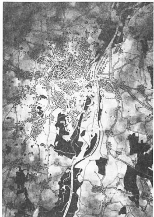
Abb. 3: Thermischer Schweif im Lee einer Großstadt. HCMM-Daten des Umlandes von Straßburg bei einer geringmächtigen NW-Strömung (Straßburg-Entzheim: 320°; 2,0 m/sec).
