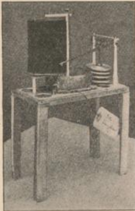
Apparat nach Assmann mit Bourdon-Rohr.
