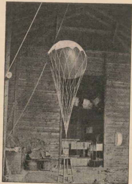
Ballon-sonde aus Para-Gummi, fertig montirt zum Aufsteigen.
