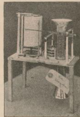
Apparat Assmann mit Metallthermometer und Strahlungsschutz.
