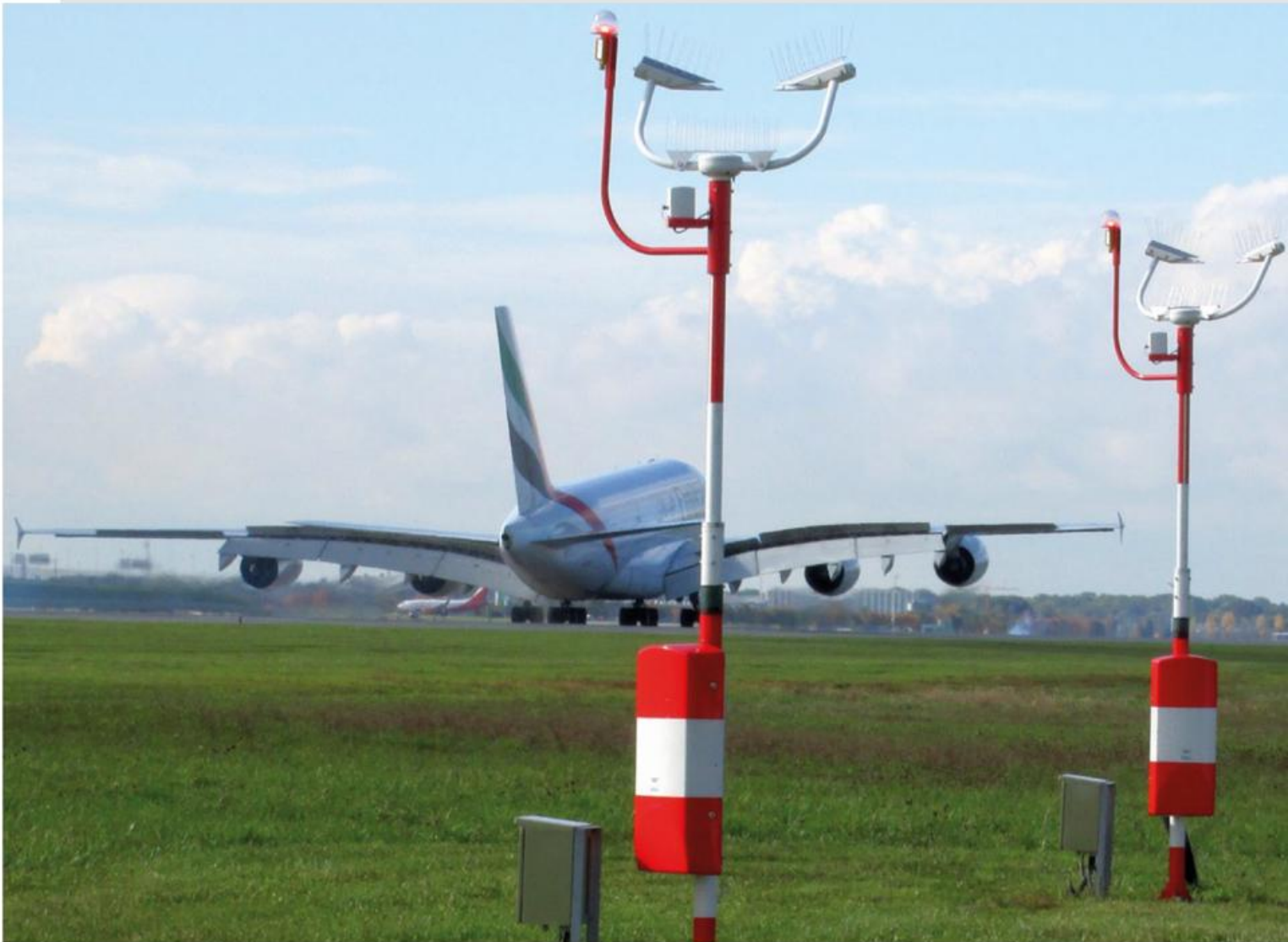
© Carolin Charina Jeromin, Sichtweitensensoren des DWD im Runway-Bereich des Flughafens Frankfurt am Main (EDDF; 50,03 N; 08,57 E; 111 m/364 ft AMSL)
