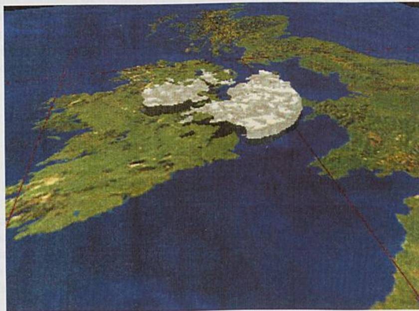
Abb.6 3D Radarwolken Darstellung über digitalem Geländemodell [4]
