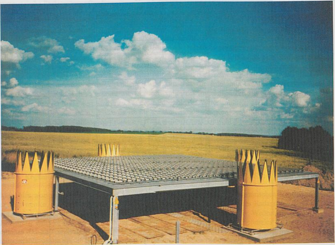
Abb. 7 Ansicht der 482 MHz-WPR-Antenne mit vier akustischen Quellen um die Antenne herum für die Temperatursondierung
