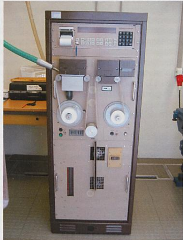
Abb. 7: Beta-Schrittfilteranlage, Frieseke und Höpfner
