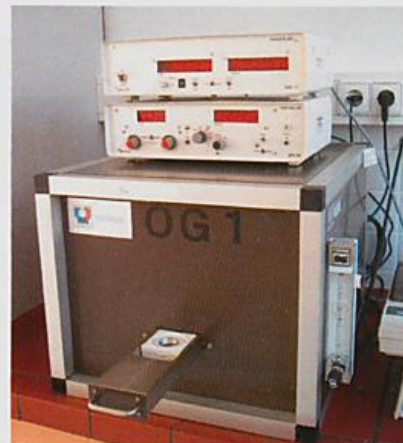
Abb. 13: Messplatz zur Bestimmung der Betaaktivität im Niederschlag
