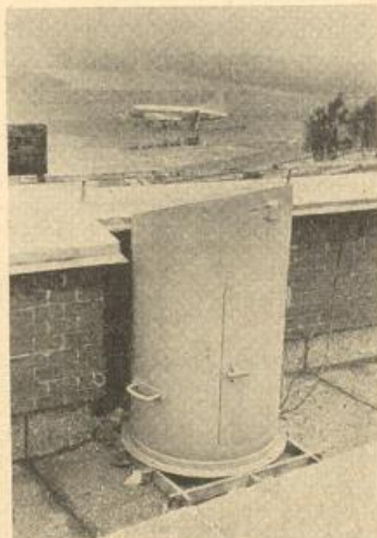
Abb. 9 Lichtimpuls-Sender Tages-Wolkenhöhenmesser, System Instrumentenamt Hamburg Dr. Früngel
