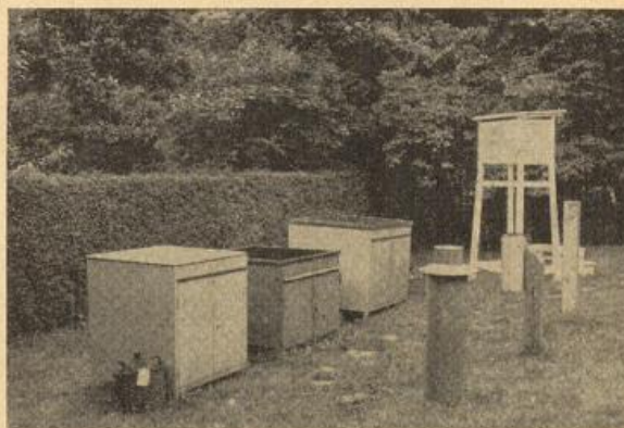
Abb. 10 Auffangwannen für radioaktiven Niederschlag bei der MMB Königstein
