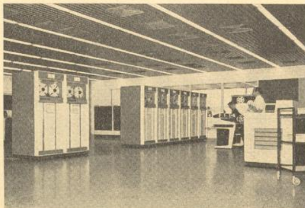
Abb. 5 Großrechenanlage des Deutschen Wetterdienstes, Teilansicht der CDC 3400 links: 8 Magnetbaineinheiten, Bildmitte: Bedienungspult, rechts: Lochkartenleser (Lesegeschwindigkeit 1200 Karten pro Minute)
