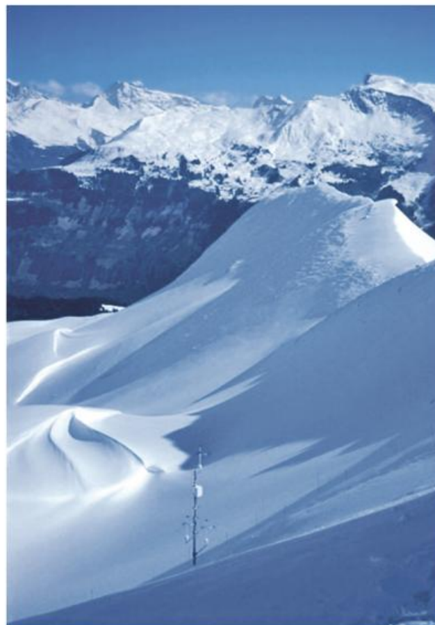
Abb. 5-1: Versuchsfeld „Gaudergrat“ mit Windmessstation und typischen Schneeverfrachtungsmustern wie Dünen, Wechten und abgeblasenen Rücken (Foto: Peter Gauer, SLF).
