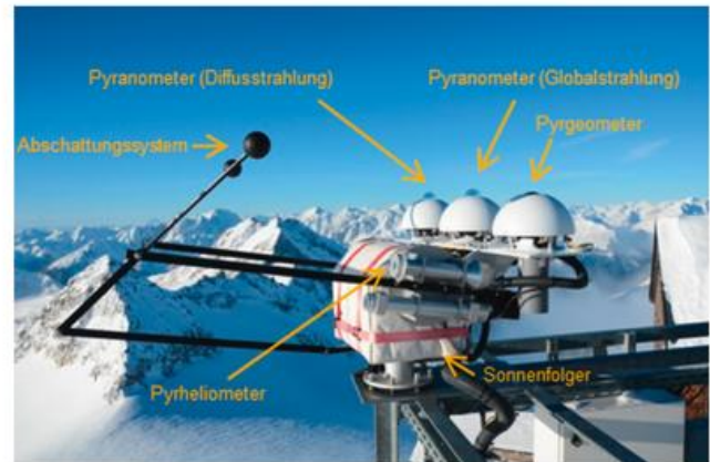
Abb. 2-1: ARAD-StationSonnblick (Quelle: Gernot Weyss, ZAMG, modifiziert), Messgeräte auf Sonnenfolger montiert: Pyrhe-liometer, Pyrgeometer, Pyranometer (Globalstrahlung beziehungs-weise Diffusstrahlung).
