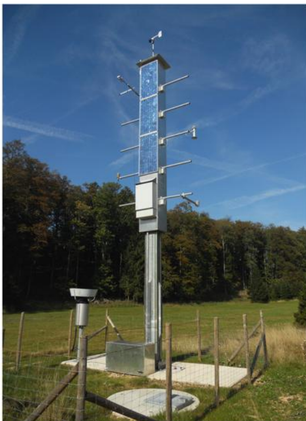
Abb. 4-18: Messgerätelift MetLift in voll ausgefahrenem Zustand am Trafelberg.
