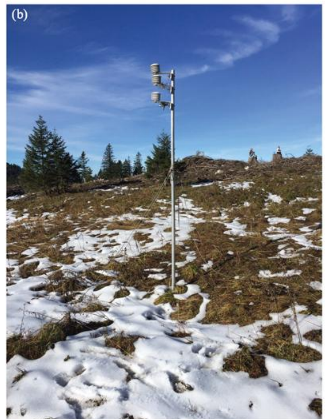
Abb. 4-3: (a) Sensoranordnung Grünloch Dolinenboden: Drei Temperatursensoren mit 1,2 m, 2,2 m und 3,2 m Abstand über Grund; (b) Ahornboden: Drei Temperatursensoren mit 2 m Abstand über Grund.
