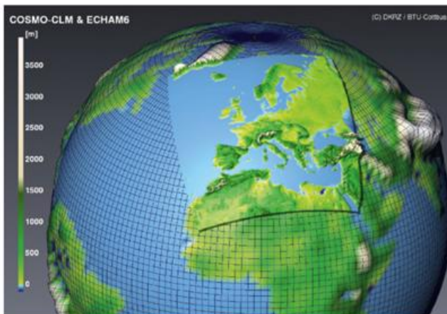
Abb. 4-1: Nestungsprinzip der dynamischen Regionalisierung, dargestellt anhand der Orographie eines globalen Modells und eines eingebetteten (genesteten) Regionalmodells.
