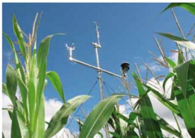
Abb. 1-4: Mikrometeorologische Messeinrichtung über einem Maisbestand.
