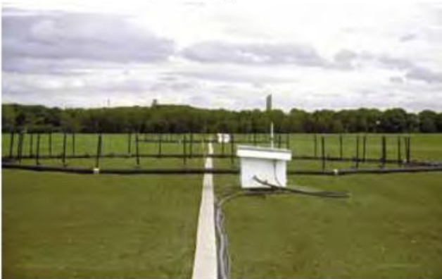
Abb. 3-3: Braunschweiger FACE-Anlage. Oben: schematische Darstellung der Aufsicht und Querschnitt eines Begasungsringes. Unten links: Foto zweier Versuchsrings kurz nach dem Aufbau (Oktober 1999) während des Fruchtfolgeversuchs mit Wintergerste (nach DÄMMGEN 2000). In den weißen Schränken befindet sich unter anderem das Steuerungsventil zur Dosierung des \text{CO}_2 . Das Gebläse, mit dem das \text{CO}_2 mit Luft verdünnt und in die Ringleitung eingeblasen wird, ist durch die Schränke verdeckt. Unten rechts: Foto mit Detailansicht der Ringleitung und eines Ausströmröhres mit pneumatischer Klappe.“
