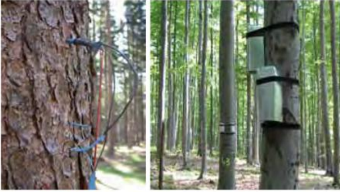
Abb. 9-6: Saftflussmessung nach Granier, links: Beispiel für den Einbau des Sensorpaares in einen Fichtenstamm, rechts: Ausschnitt einer Messanlage mit 10 Bäumen zur repräsentativen Bestimmung der Transpiration T^* von einem Buchenbestand im Tharandter Wald.
