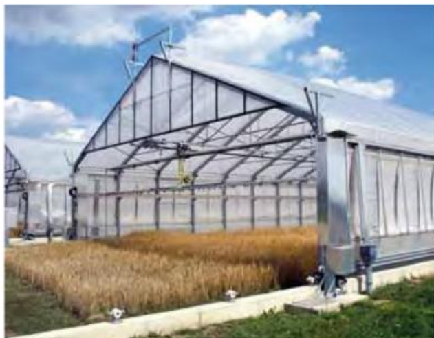
Abb. 1-9: Automatischer Rain-out Shelter des Instituts für Pflanzenbau und Bodenkunde (Julius Kühn-Institut, Braunschweig).
