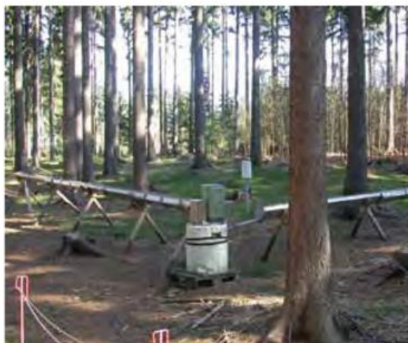
Abb. 9-3: Links: Messanlage zur Erfassung der Kronentraufe mittels Auffangrinnen (in DVWK, 1986, als Regenrinne bezeichnet) in einem Fichtenbestand im Tharandter Wald; rechts: im gleichen Bestand gemessene Kronentraufe in Abhängigkeit des Freilandniederschlags (Sommer 2006), zusätzlich gezeigt werden die potentiellen Grenzen für P_n sowie der mittlere statistische Zusammenhang zwischen Niederschlag und Bestandeswassereintrag pro Ereignis.
