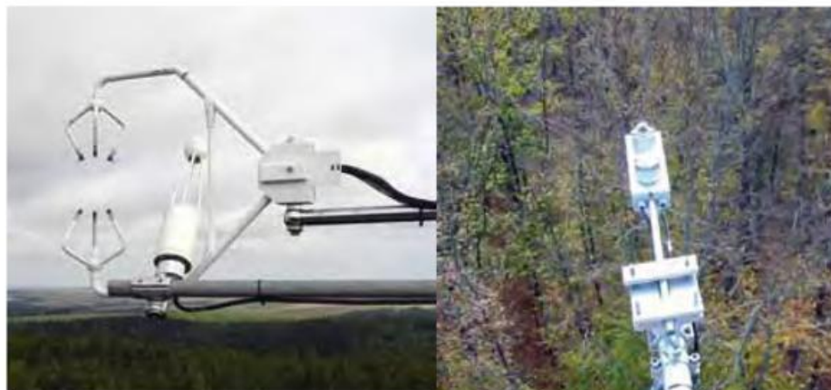
Abb. 9-5: Eddy-Kovarianz- (EC-) Messsystem zur Erfassung der Evapotranspiration über einem Buchenbestand im Tharandter Wald; links: EC-Messsystem bestehend aus Ultraschallanemometer (Campbell, CSAT3) und Open-Path-Gasanalysator (LI-COR, LI 7500); rechts: Messsystem zur Erfassung der Nettostrahlung und aller Strahlungsbilanzkomponenten (Kipp & Zonen, CNR1).
