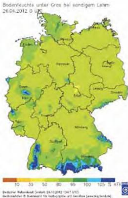
Abb. 6-2: Berechnete Bodenfeuchte unter Gras bei sandigem Lehm in den obersten 60 cm. Werte in Prozent nutzbarer Feldkapazität.
