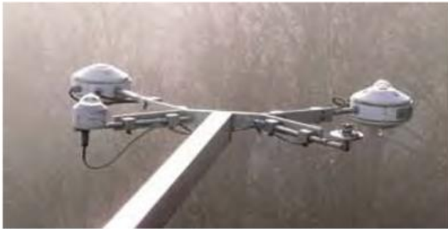
Abb. 8-9: Messwertgeber für die kurzwelligen (rechts hinten) und die langwelligen Strahlungsflussdichten (links hinten) aus der oberen und unteren Hemisphäre über einem Buchenbestand bei Möhringen sowie für die UV-A/B-Strahlung (links vorne) und PAR (rechts vorne) aus der oberen Hemisphäre.
