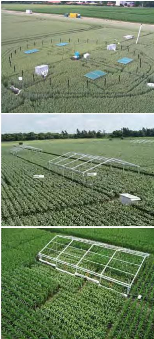
Abb. 3-4: Aufsicht auf einen Begasungsring während der drei FACE-Versuchsreihen (siehe Tabelle 3-1). Oben: Ring mit Winterweizen (Juni 2005) aus dem Fruchtfolge-Experiment mit Bestandesgaswechselkammern und schattierten Teilflächen; die linke Kreishälfte ist mit reduzierte N-Düngung versorgt. Mitte: Ansicht des Maisversuchsfeldes (Juli 2008) mit einem FACE-Ring im Vordergrund und einem Kontrollring im Hintergrund links; jede Ringfläche ist in eine feuchte und trockene Hälfte unterteilt. Unten: Parzellen mit vier Sorghum-Sorten und einer Maissorte (unten links und oben rechts) in der feuchten und trockenen Ringhälfte (mit Regenausschlusszelt, aber ohne Plane im Juli 2011).
