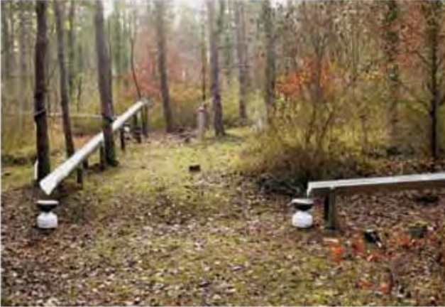
Abb. 8-6: Regenrinnen an der Forstmeteorologischen Messstelle Hartheim zur Erfassung des bestandesrepräsentativen Kronendurchlasses unter einem aufgelockerten Kronenschirm.
