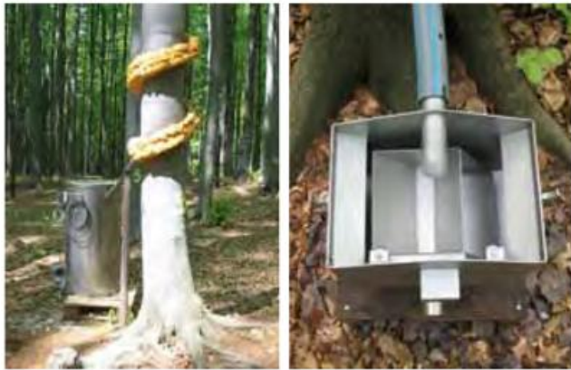
Abb. 9-2: Messanlagen zur Erfassung des Stammabflusses; links: spiralförmige Auffangrinne und Auffanggefäß (ausgerüstet mit Drucksonde zur Erfassung des Füllstandes und automatischer Entleerung); rechts: Messwippe der Firma UGT mit Kippschalen (100 ml).
