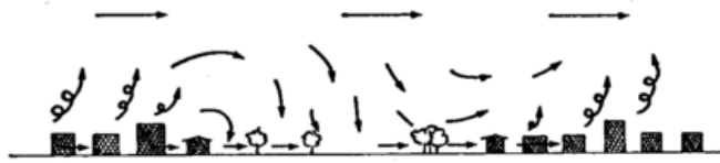
Abb. 6.5: Schematische Darstellung der Luftströmung über einem städtischen Park bei schwachem Regionalwind.
