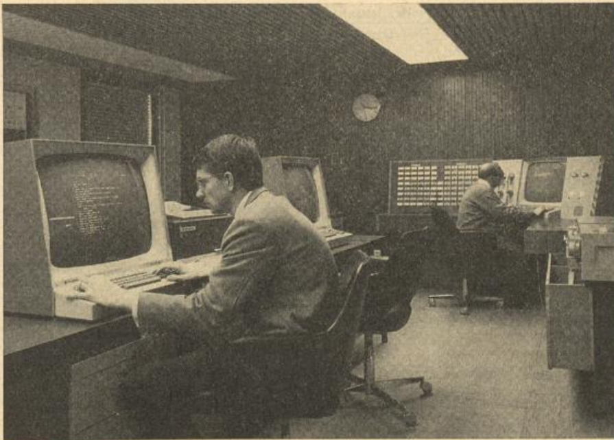
Abb. 18 Betriebs- und technische Überwachungsplätze der Fernschreibspeichervermittlung (AEG Werkfoto)
