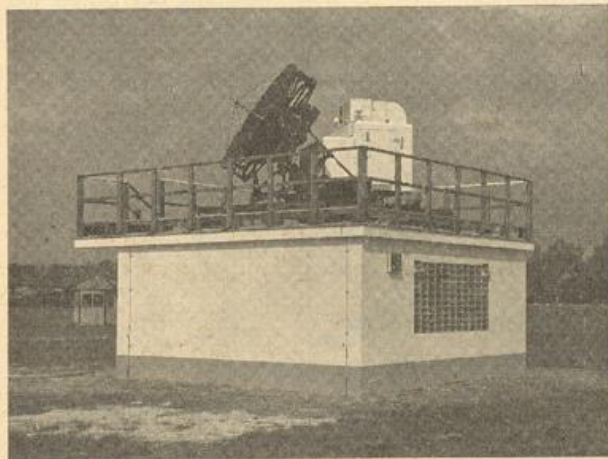
Abb. 14 Höhenwindmeßradargerät Decca WF 2 beim Wetteramt Berlin
