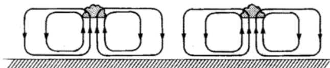
Abb. 2: Asymmetrie von Konvektionsrollen bei labiler Schichtung, schematisch.
