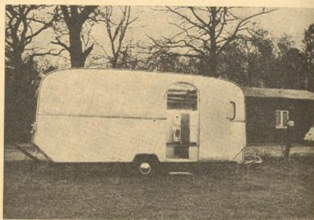
Abb. 12 Meßanhänger für digitale Registrieranlage, Außenansicht
