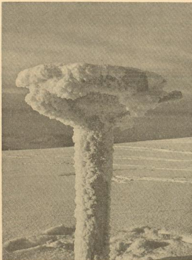
Abb. 17 Totalisator mit Windschutz nach Fink auf dem Feldberg Foto: B. Mikuteit
