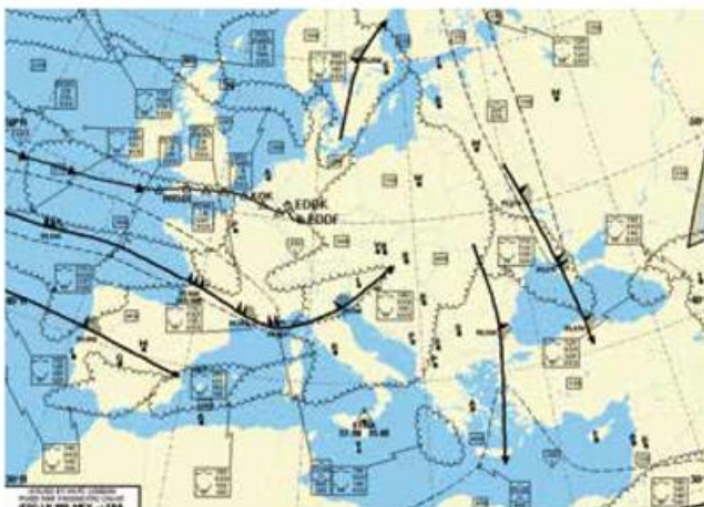
Abb. 8-11: Sig-Wx-Chart für Europa, FL 100 bis FL 450 (mit freundlicher Genehmigung der Fa. Lufthansa Systems, Lido/Flight).
