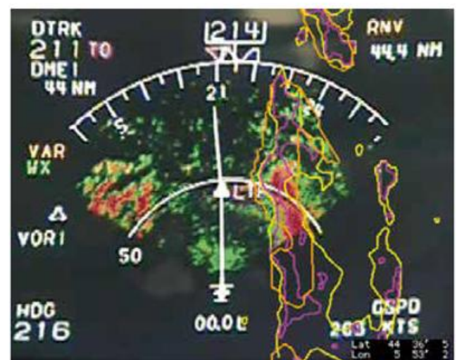
Abb. 5-1: Schnappschuss eines Videos der aufgezeichneten Reflektivitäten des Bordradars des französischen Forschungsflugzeuges SAFIRE ATR-42 nahe Grenoble am 19. August 2008 um 14:05 UTC. Dem Bild sind nachträglich die Konturen der vom Bodensystem detektierten Gewitterzellen überlagert. Die farbigen Flächen auf dem Display weisen auf leichte (grün), moderate (orange) und starke (rot) Radarreflektivitäten hin. Die überlagerten orangenen Konturen sind Cb-TRAM-Objekte, gelbe und violette Konturen markieren Zellen mit mittlerem und starkem Niederschlag (nach TAFFERNER et al. 2010).
