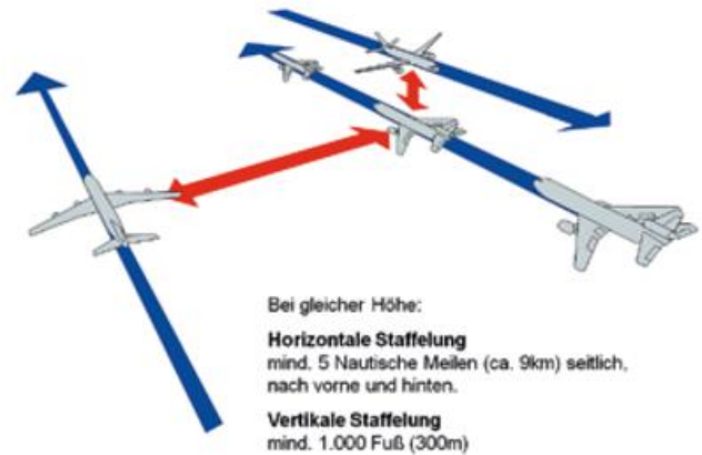
Abb. 4-1: Die wichtigste Aufgabe des Flugverkehrsleiters ist die Gewährleistung der horizontalen und vertikalen Sicherheitsabstände („Staffelung“ = rote Pfeile) ( http://www.austrocontrol.at ).
