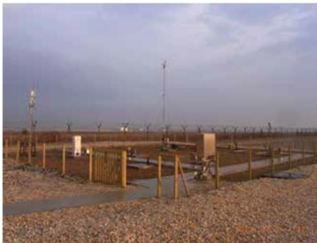
Abb. 7-3: Klimagarten (Messfeld) im Feldlager Masar-e Scharif. Der Aufbau und Betrieb der Messgeräte orientiert sich am WMO/ICAO-Standard, Bildquelle: Bundeswehr.
