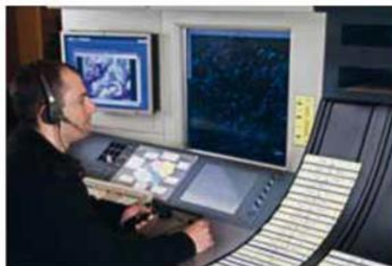
Abb. 4-8: Alle wichtigen Informationen werden mit dem sogenannten Label auf dem Radarschirm dargestellt (links). Wetterinformationen werden meist auf einem Support-Screen (links vom Radarschirm) dargestellt (Foto rechts http://austrocontrol.at ).
