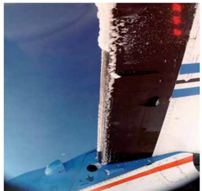
Abb. 17-1: Das Forschungsflugzeug DLR Dornier 228 nach dem Durchflug von Vereisungsbedingungen während der Messkam-pagne EURICE (Quelle: Thomas Hauf, ehemals DLR, 1998).
