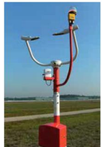
Abb. 20-7: Sichtweitenmessgerät auf Basis der Streuungsmessung (Scatterometer). Gezeigtes Gerät: FS11 von Vaisala. Quelle: DWD.
