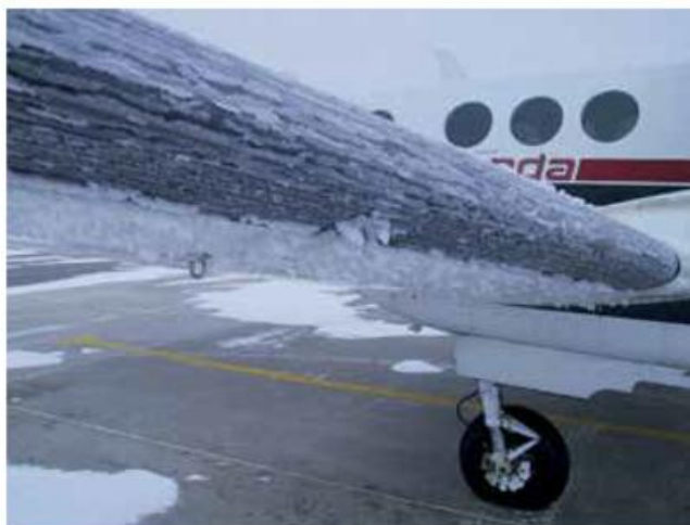
Abbildung 17-3: Tragflächenprofil nach dem Einsatz der pneumatischen Enteisungsanlage. Vor allem unterhalb der Tragfläche sind Eisablagerungen zu erkennen, die durch ihre Lage hinter der Gummiwerkleitung nicht entfernt werden konnten und somit die Aerodynamik der Tragfläche weiterhin stören (Quelle: http://www.altair.com.pl/news/view?news_id=5384 , übernommen aus der Aviation Multimedia Library ).
