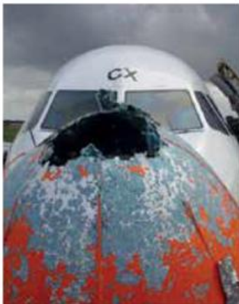
Abb. 16-6: Hagelschaden am Radom des Airbus A319, der am 1. Oktober 2009 auf dem Flug von Forlì nach Palermo in eine Hagelzelle geraten war (Foto: ATRDRIVER).
