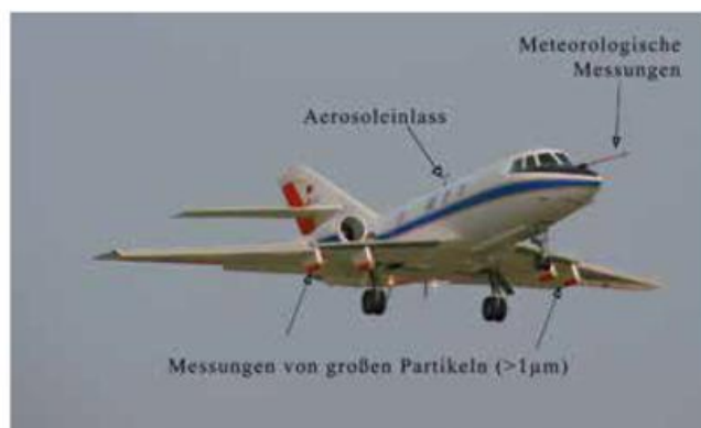
Abb. 21-3: Das DLR-Forschungsflugzeug Falcon 20-E. Unter den Flügeln befinden sich die Instrumente zur Detektion der großen (> 1 µm) Partikel.
