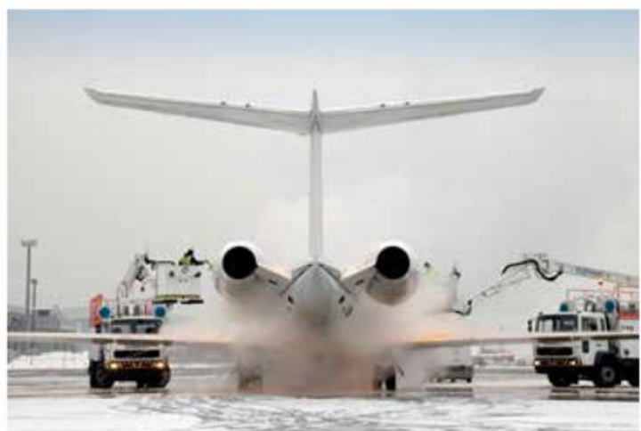
Abb. 18-4: Flugzeugenteisung am Verkehrsflughafen Frankfurt/Main (© Fraport AG).
