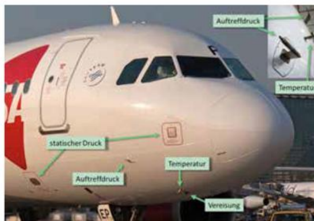
Abb. 22-1: Die Messpositionen für statischen Druck, Auftreffdruck, Temperatur und Vereisung an einem Airbus A319 (Foto: Björn Schmitt). Oben rechts ist die Nahaufnahme des Pitotrohrs (Auftreffdruck) und des TAT-Gehäuses (Temperatur) auf der Backbordseite eines Embraer-Flugzeugtyps (Foto: Lufthansa AG) zu sehen.
