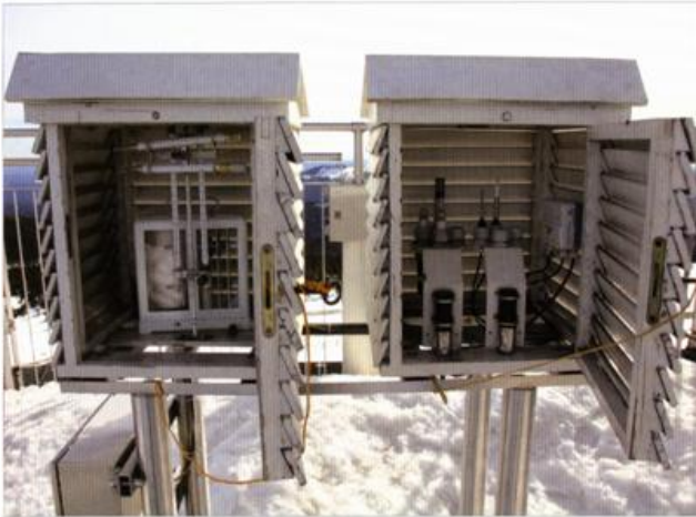
Abb. 6: Klimahütte mit konventioneller Messtechnik (links), die elektronischen Temperatur- und Feuchtefühler (rechts), aufgenommen im März 2015 (Quelle: Marc Kinkeldey)
