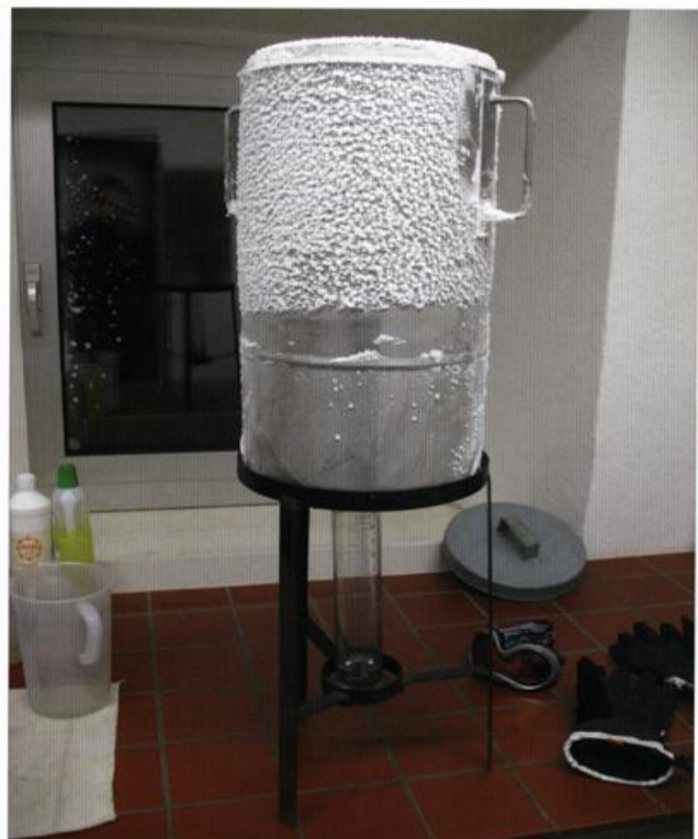
Abb. 10: Gestell mit Niederschlagstopf und Messglas zur Bestimmung der Niederschlagsmenge im Winter (Quelle: Marc Kinkeldey)
