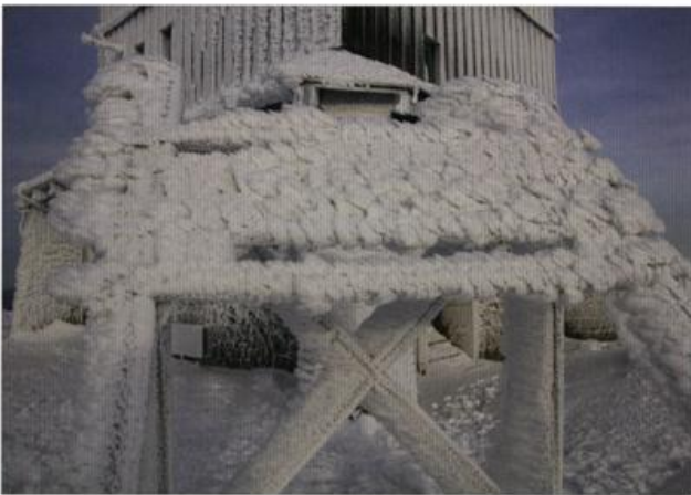
Abb. 8: Probenahmegerüst der TU Bremen auf dem Brocken mit Eisansatz, Winter 2015
