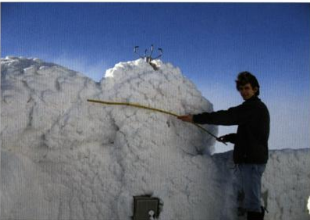
Abb. 2: Weit über 200 cm starke Nebelfrostablagerungen am 13. März 2006 an den Testgeräten (Quelle: Marc Kinkeldey)
