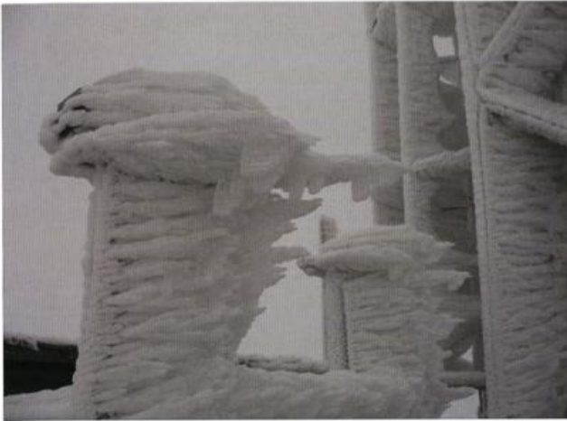
Abb. 4: Automatischer Sonnenscheinmesser „Soni“, nach 24 Stunden Nebel mit starken Eisablagerungen überzogen, aufgenommen am 24. November 2013 (Quelle: Marc Kinkeldey)
