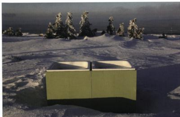
Abb. 4: Sammelwannen für Radioaktivitätsmessung im Niederschlag (Quelle: Marc Kinkeldey)
