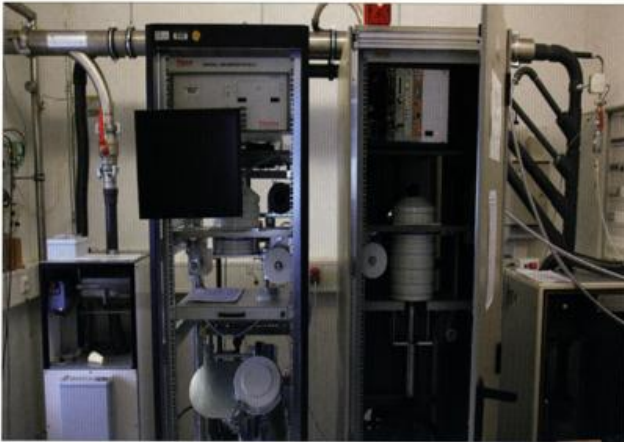
Abb. 1: Wochenfiltermessung - Anlage für gasförmiges Jod (links) und nuklidspezifischer Aerosolmonitor (rechts), (Quelle: Marc Kinkeldey)
