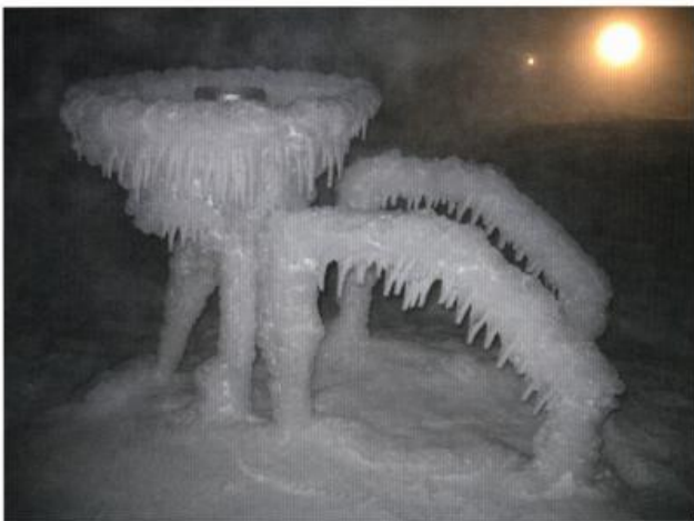
Abb. 4: Eisregen überzieht den Hellmann'schen Gebirgsregensmesser, aufgenommen am 11. Dezember 2010 (Quelle: Marc Kinkeldey)
