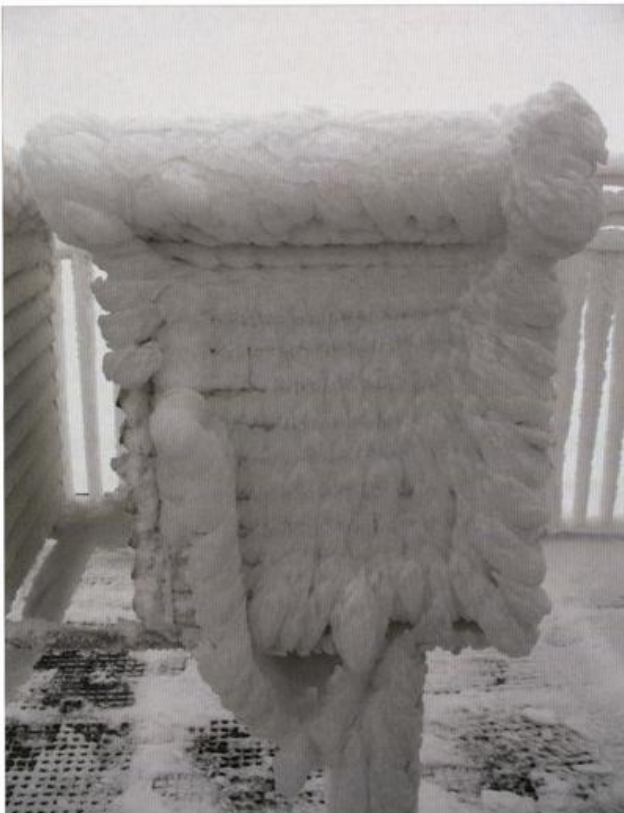
Abb. 5: Klimahütte mit automatischer Sensorik (Temperatur- und Feuchtemessung, aufgenommen am 24. November 2013 (Quelle: Marc Kinkeldey)
