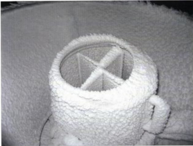
Abb. 11: Niederschlagstopf im Winter mit Nebelfrostablagerungen (Quelle: Marc Kinkeldey)
