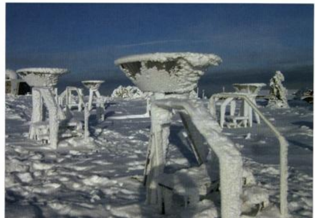
Abb. 3: Gebirgsregenmesser nach Hellmann mit Nebelfrostablagerungen (Quelle: DWD Hamburg)
