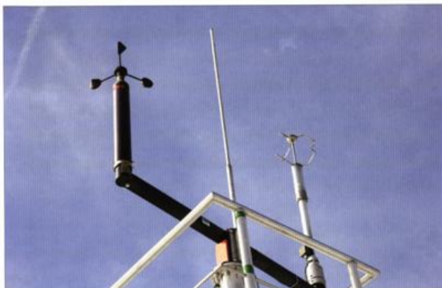
Abb. 17: Links ein Schalenkreuzanemometer, rechts zu Testzwecken ein Ultraschallwindmesser (USA 3D), (Quelle: Marc Kinkeldey)
