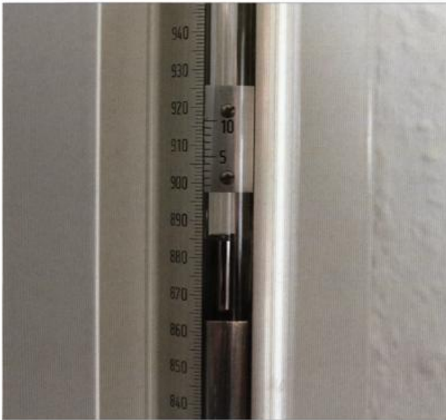
Abb. 19: Skala mit Nonius zur Ablesung des aktuellen Stationsluftdrucks (Quelle: Marc Kinkeldey)
