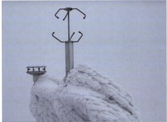
Abb. 6: Eisfreie Windmessgeräte auf dem Dach der Wetterwarte (Quelle: DWD Hamburg)
