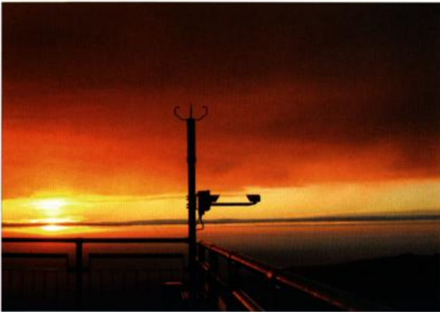
Abb. 1: Ultraschallwindmesser und Wettersensor im Herbst 2005 (Quelle: Marc Kinkeldey)
