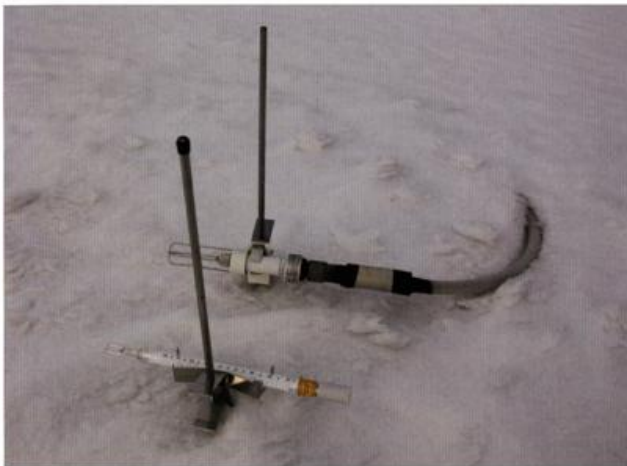
Abb. 7: Elektronisches und konventionelles Thermometer in 5 cm über dem Erdboden (Quelle: Marc Kinkeldey)
