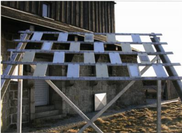
Abb. 7: Probenahmegerüst der TU Bremen auf dem Brocken ohne Eisansatz, Herbst 2015 (Quelle: Marc Kinkeldey)
