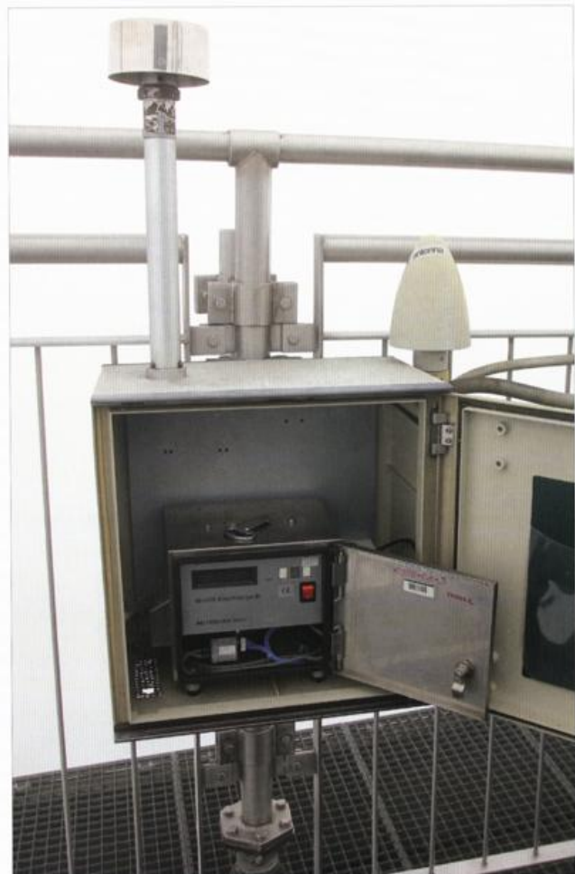
Abb. 5: Messgerät zur Luftüberwachung: MiniVs zur Feinstaubmessung (Quelle: Marc Kinkeldey)
