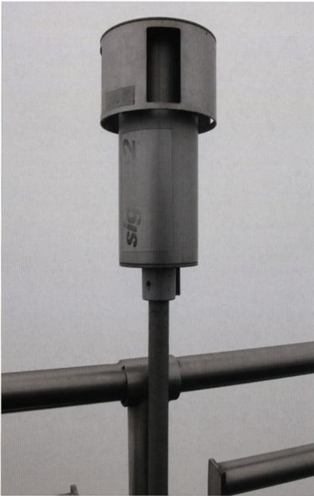
Abb. 6: Messgerät zur Luftüberwachung: Sigma 2 für Grobstaub und NO 2 (Quelle: Marc Kinkeldey)
