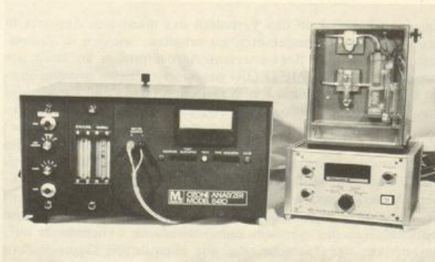
Abb. 15: Geräte zur kontinuierlichen Bestimmung des bodennahen Ozons, links nach photochemischem, rechts nach naßchemischem Verfahren
