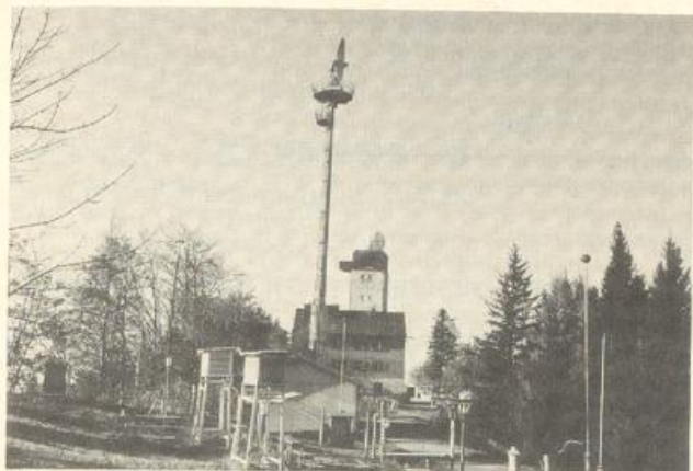
Abb. 30: Blitzzähler (senkrechte Antennenstäbe mit faustgroßen Kugeln am oberen Ende) auf dem Hauptmeßfeld des Observatoriums Hohenpeißenberg
