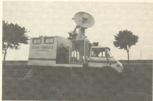
Abb. 23: Mobiles Radargerät der Wetter-Meßzüge zur Bestimmung des Höhenwindes
